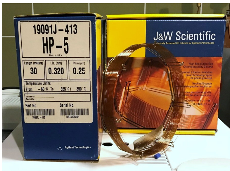
Slika 3.3. Slika korištene kapilarne kolone Agilent HP-5 19091J-413
