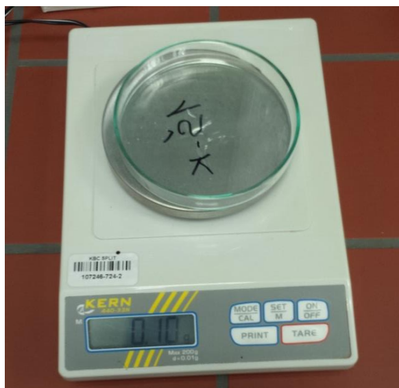
Slika 12. Tehnička vaga s odvaganim uzorkom (0,1 g).
