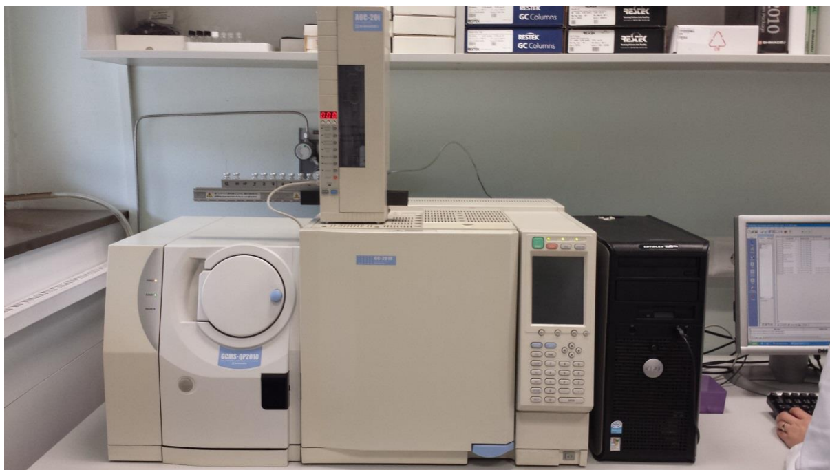
Slika 14. Plinski kromatograf sa spektrometrom masa, Shimadzu GCMS-QP2010.
