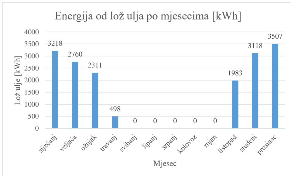
Slika 5.6 - Potrošnja lož ulja u kilovat satima [kWh]
