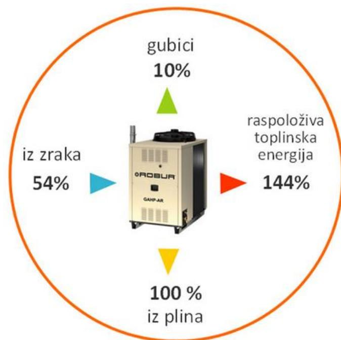
Slika 3.1 - Energetska bilanca apsorpcijske plinske dizalice topline [3]
