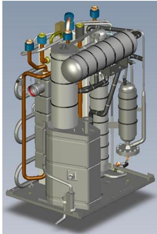
Slika 3.9 - 3D prikaz apsorpcijske plinske dizalice topline [6]
