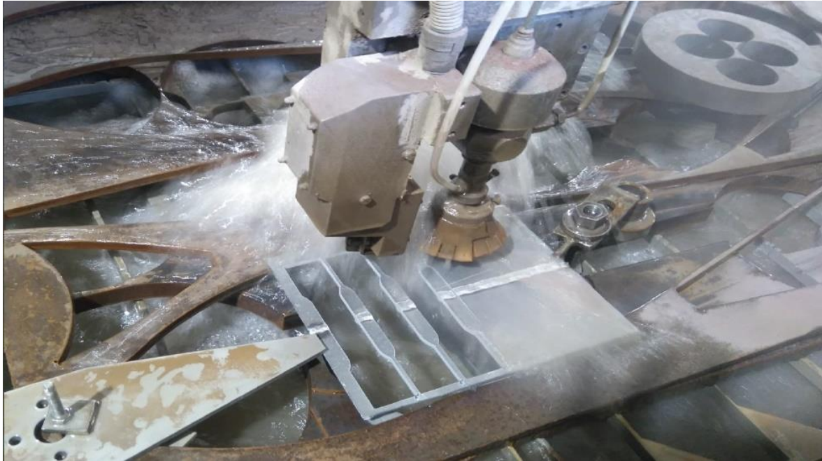
Slika 5.9 Oblikovanje ispitnih uzoraka
