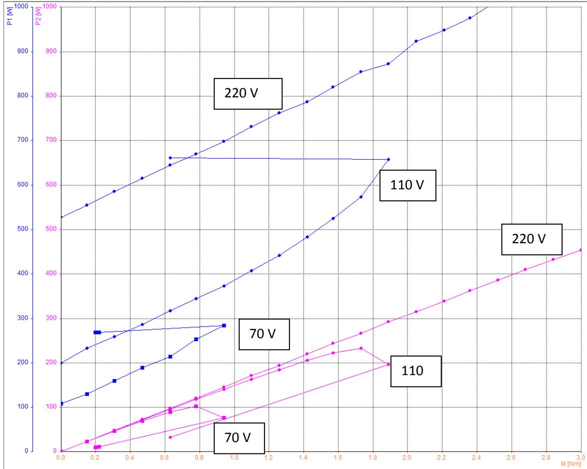
Dijagram 4. Ovisnost električne  $P_1$  i mehaničke snage  $P_2$  o momentu opterećenja za napone 220 V, 110 V, 70 V
