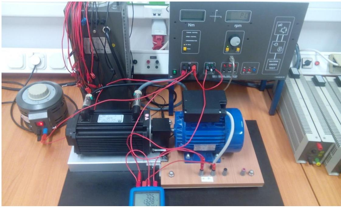
Slika 18. Shema spoja jednofaznog asinkronog motora u laboratoriju
