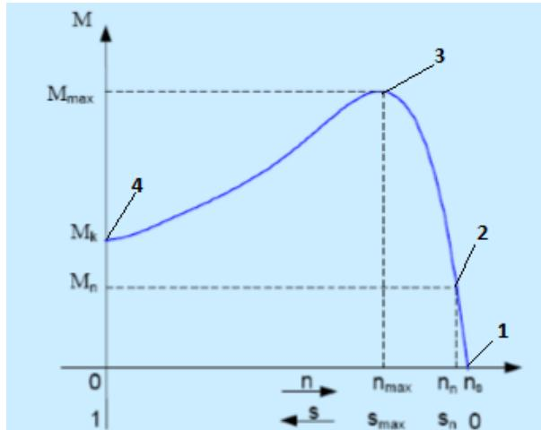
Slika 14. Momentna karakteristika asinkronog motora s karakterističnim točkama. [2]
