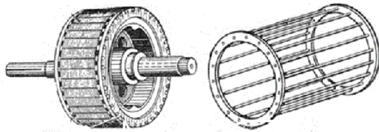
Slika 4. Dijelovi kavezognog motora. [6]
