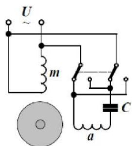
Slika 27. Shema spoja reverziranja zamjenom priključaka pomoćne faze. [7]
