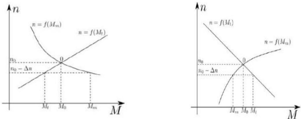
Slika 8. Prikaz stabilne i nestabilne radne točke elektromotornog pogona.[8]
