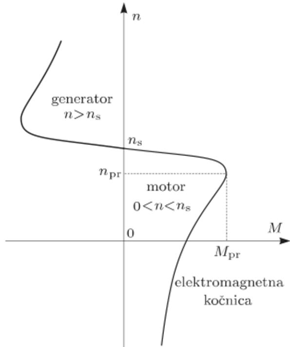
Slika 6. Vanjska karakteristika asinkronog stroja za tri režima rada. [8]
