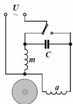
Slika 28. Shema spoja reverziranja motora s jednakim namotima radne i pomoćne faze. [7]
