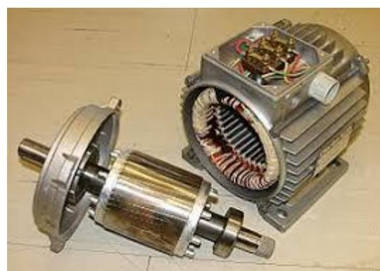
Slika 3. Kavezni motor sa rotorom izrađenim od aluminija. [6]
