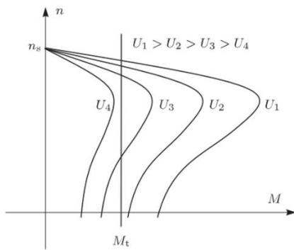
Slika 13. Momentna karakteristika motora s promjenjivim naponom napajanja. [2]
