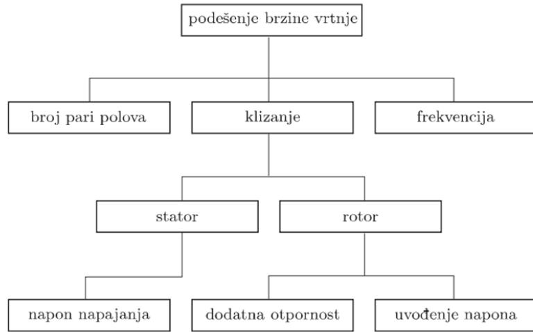
Slika 15. Mogućnosti podešenja brzine vrtnje asinkronog motora[1]
