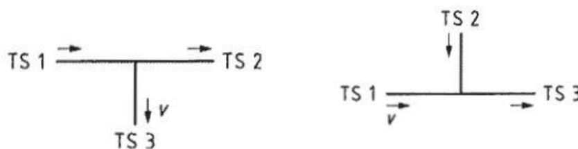
Slika 4.1 - Označavanje t komada prema DIN 1988-300 [10]
