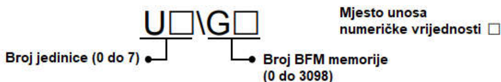
Slika 3.4. Instrukcija za odabir jedinice PLC sustava i BFM memorije [8]
