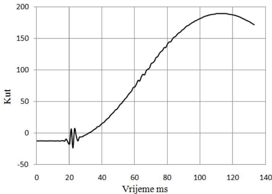
Slika 2.6 Dijagram mjerena rotacijskim potenciometrom
