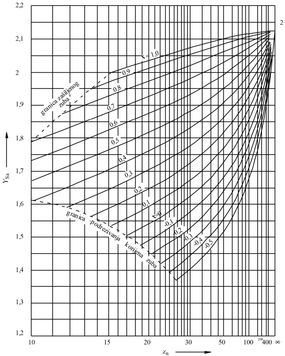
Slika 3.10 Faktor koncentracije naprezanja u korijenu zuba zupčanika s vanjskim ozubljenjem za alat u obliku zubne letve s:  $\alpha_n = 20^\circ$ ;  $h_{a0} = m$ ;  $h_{f0} = m$ ;  $\rho_{F0}^* = 0,3$  [10]
