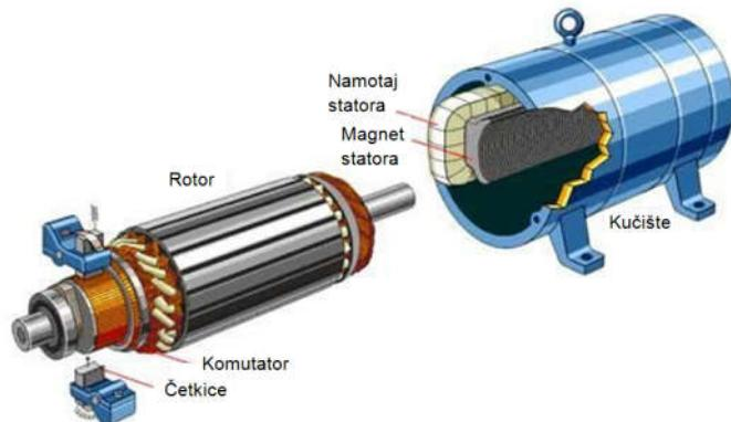
Slika 3.2 Shematski prikaz motora na istosmjernu struju [6]
