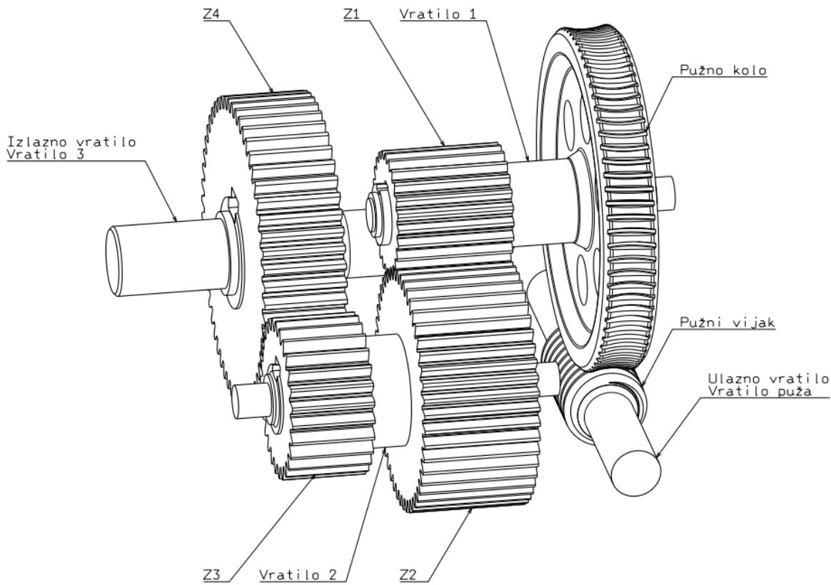
Slika 3.5 Sklop zupčanog prijenosa  $i = 300$
