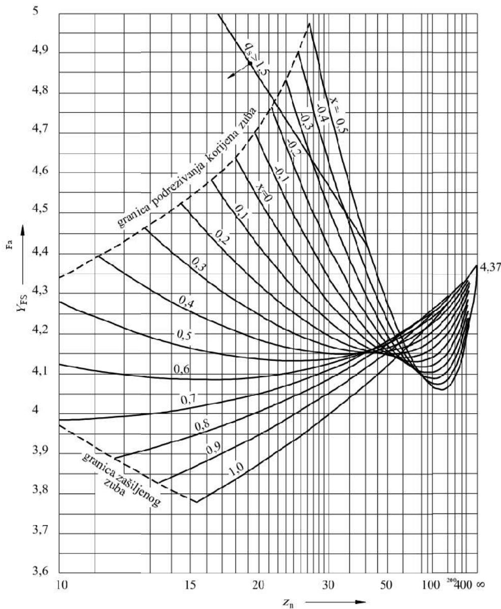
Slika 3.7 Efektivni faktor oblika zuba  $Y_{FS}$  zupčanika s vanjskim ozubljenjem za alat u obliku rezne letve s:  $\alpha_n = 20^\circ$ ;  $h_{a0} = m$ ;  $h_{f0} = 1,25m$ ;  $\rho_{F0}^* = 0,3$  [10]
