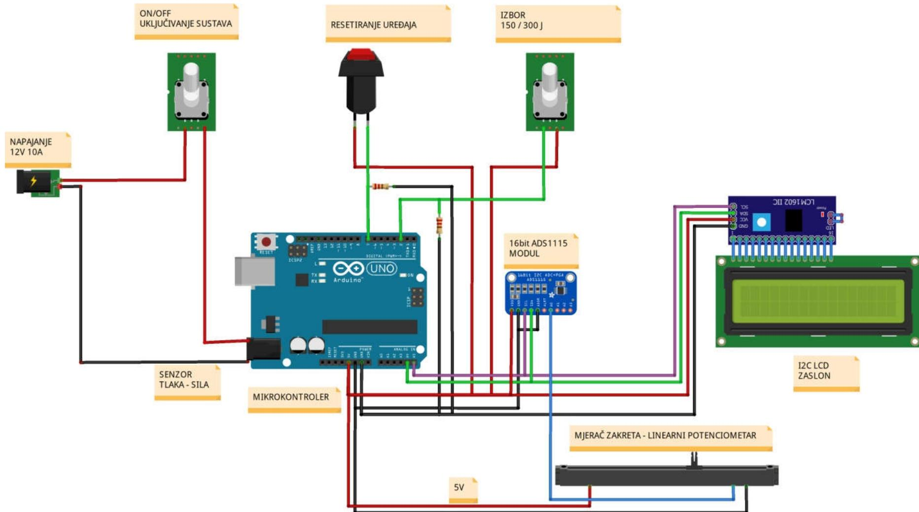
Slika 2.9 Elektronička shema spajanja dijelova za digitalno mjerjenje
