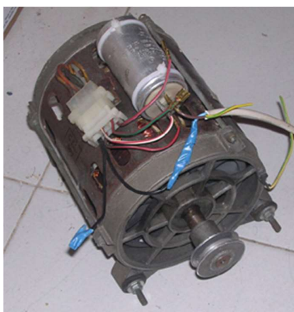
Slika 21. Asinkroni motor perilice rublja [11]
