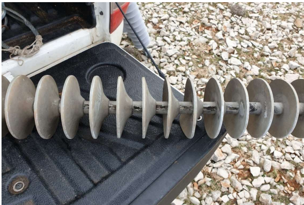
Slika 2.5. Proboj štapnog silikonskog izolatora
