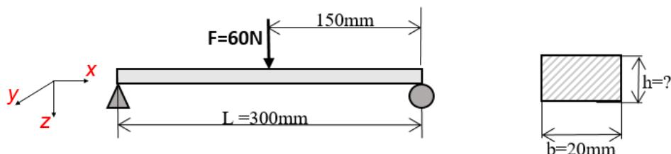
Slika 5.1 Slika opterećenja ispitne epruvete na savijanje
