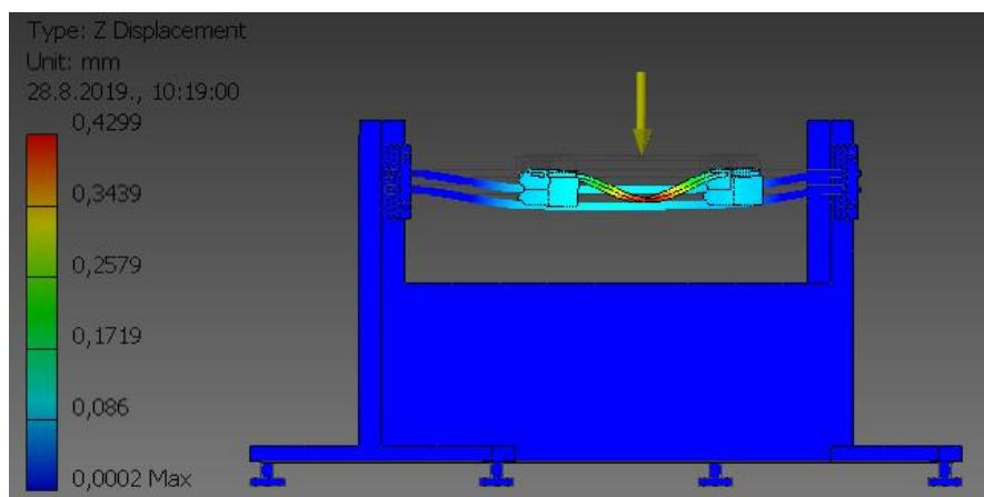
Slika 5.39 Analiza pomaka edukacijske naprave i epruvete opterećene i učvršćene prema slici 5.7 materijal epruvete: bakar (AISI C14200, Hard) [9]
