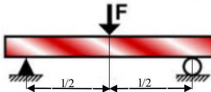
Slika 5.2 Slika opterećene ispitne epruvete na savijanje - Varijanta 1 [4]
