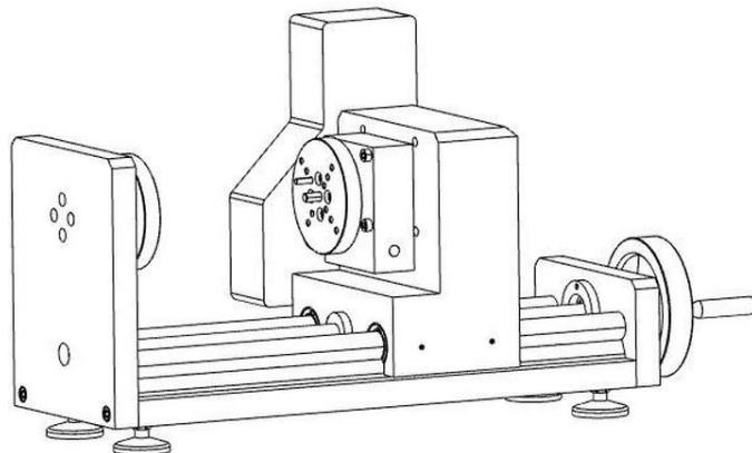
Slika 2.4 Uređaj za ispitivanje epruvete na uvijanje [6]
