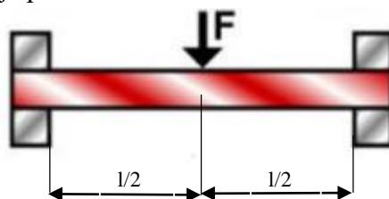
Slika 5.7 Slika opterećene ispitne epruvete na savijanje - Varijanta 2 [4]
