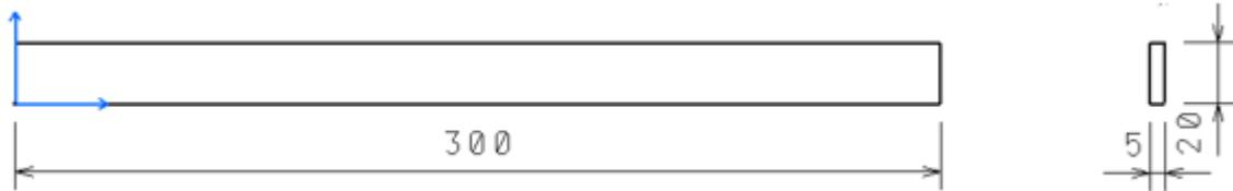
*Slika 5.33 Dimenzija ispitnih epruveta pravokutnog presjeka [8]*
