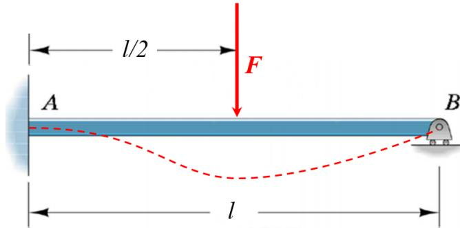
*Slika 5.17 Slika opterećene ispitne epruvete na savijanje - Varijanta 4*
