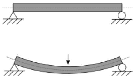
Slika 2.1 Epruveta opterećena s jednom koncentriranom silom [6]
