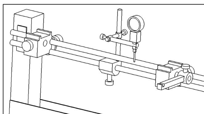
Slika 4.4 Detaljan prikaz steznih glava i mjernog uređaja [8]
