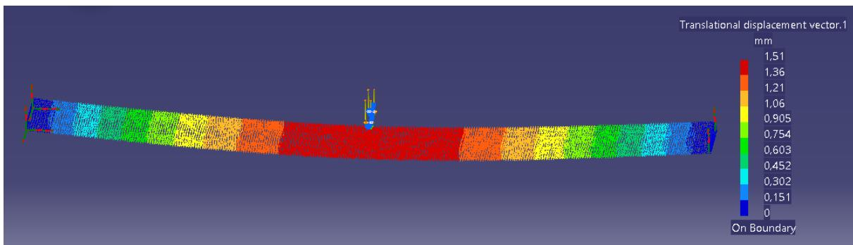
Slika 5.4 Analiza pomaka epruvete opterećene na savijanje i učvršćene prema slici 5.2 – materijal: bakar (AISI CI4200, Hard) [8]
