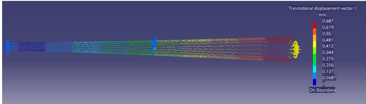
*Slika 5.28 Analiza pomaka epruvete opterećene na uvijanje i učvršćene prema slici 5.26 – materijal: bakar (AISI CI4200, Hard) [8]*
