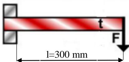
*Slika 5.12 Slika opterećene ispitne epruvete na savijanje - Varijanta 3 [4]*
