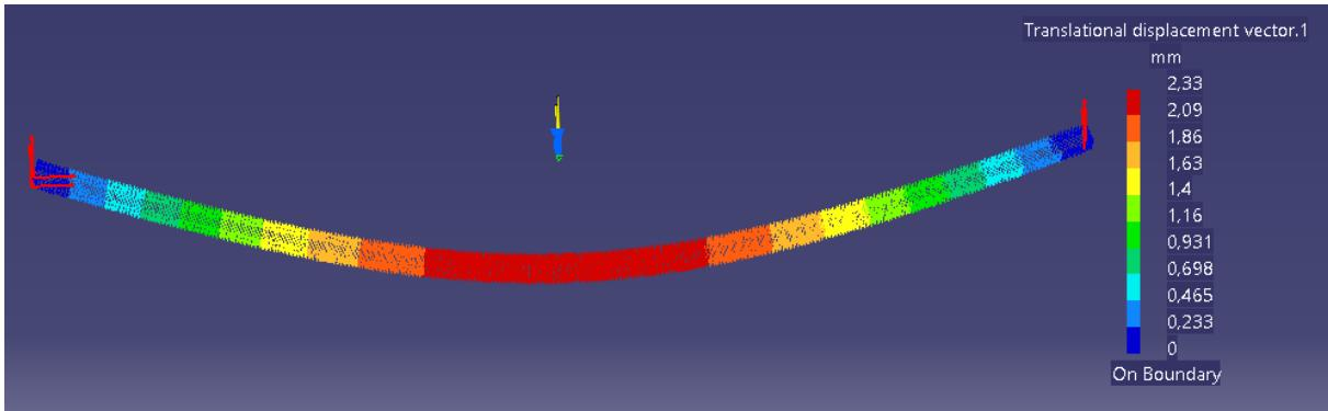
Slika 5.3 Analiza pomaka epruvete opterećene na savijanje i učvršćene prema slici 5.2 – materijal: aluminij (ANSI 6061) [8]
