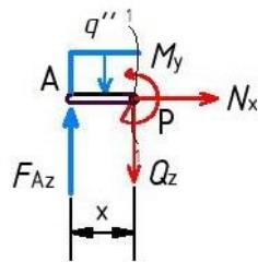
Slika 2.21 - Presjek 1-1 asimetrično opterećenog nosača
