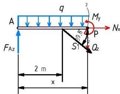
Slika 2.35 - Presjek 2-2 zadano opterećenog nosača
