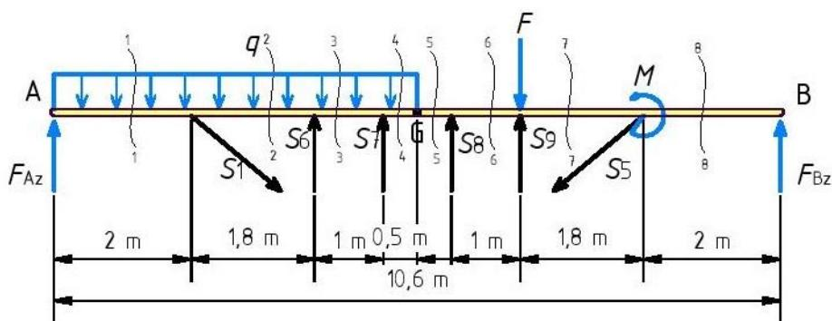
Slika 2.33 - Presjeci u neovisnim područjima za određivanje unutarnjih sila zadalog opterećenja
