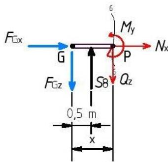
Slika 2.39 - Presjek 6-6 zadano opterećenog nosača
