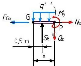
Slika 2.13 - Presjek 6-6 simetrično opterećenog nosača
