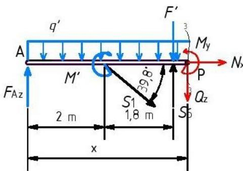
Slika 2.10 - Presjek 3-3 simetrično opterećenog nosača
