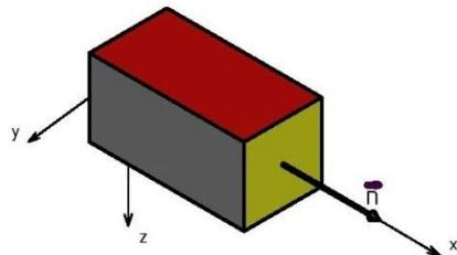
*Slika 1.3 - Pozitivan poprečni presjek*
