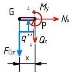
Slika 2.24 - Presjek 4-4 asimetrično opterećenog nosača
