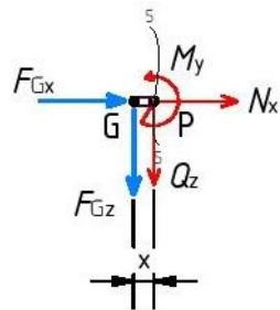
Slika 2.38 - Presjek 5-5 zadano opterećenog nosača
