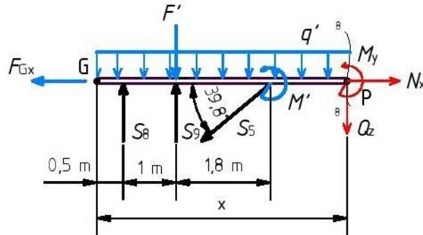
Slika 2.15 - Presjek 8-8 simetrično opterećenog nosača
