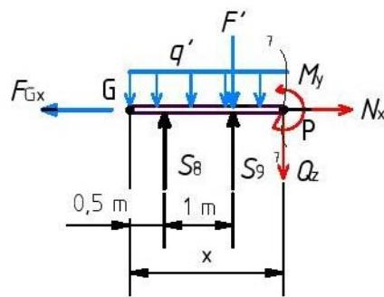
Slika 2.14 - Presjek 7-7 simetrično opterećenog nosača
