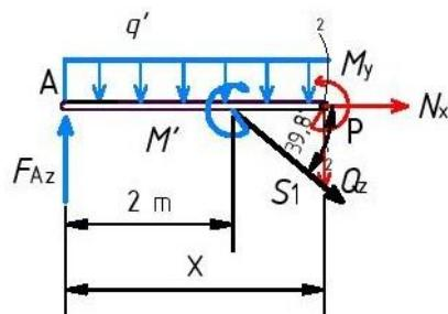
Slika 2.9 - Presjek 2-2 simetrično opterećenog nosača
