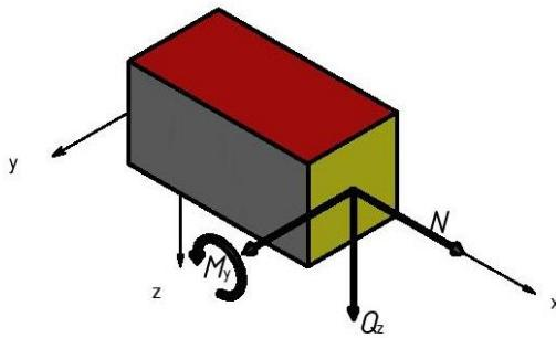
Slika 1.5 - Pozitivne unutarnje sile na pozitivnom presjeku
