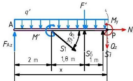
Slika 2.11 - Presjek 4-4 simetrično opterećenog nosača
