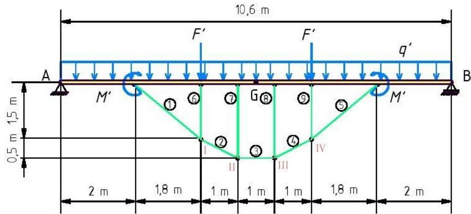
Slika 2.2 - Simetrično opterećenje zadanog ojačanog nosača
