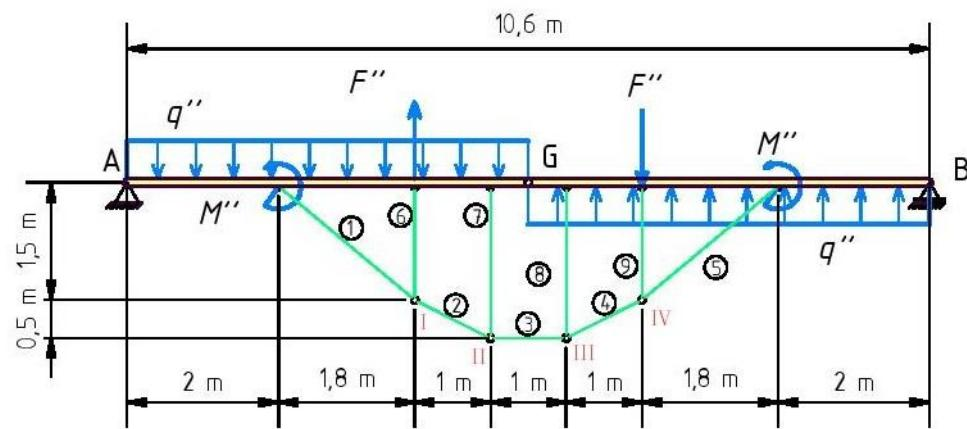
Slika 2.17 - Asimetrično opterećenje zadano ojačanog nosača
