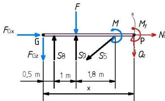
Slika 2.41 - Presjek 8-8 zadano opterećenog nosača
