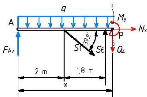
Slika 2.36 - Presjek 3-3 zadano opterećenog nosača
