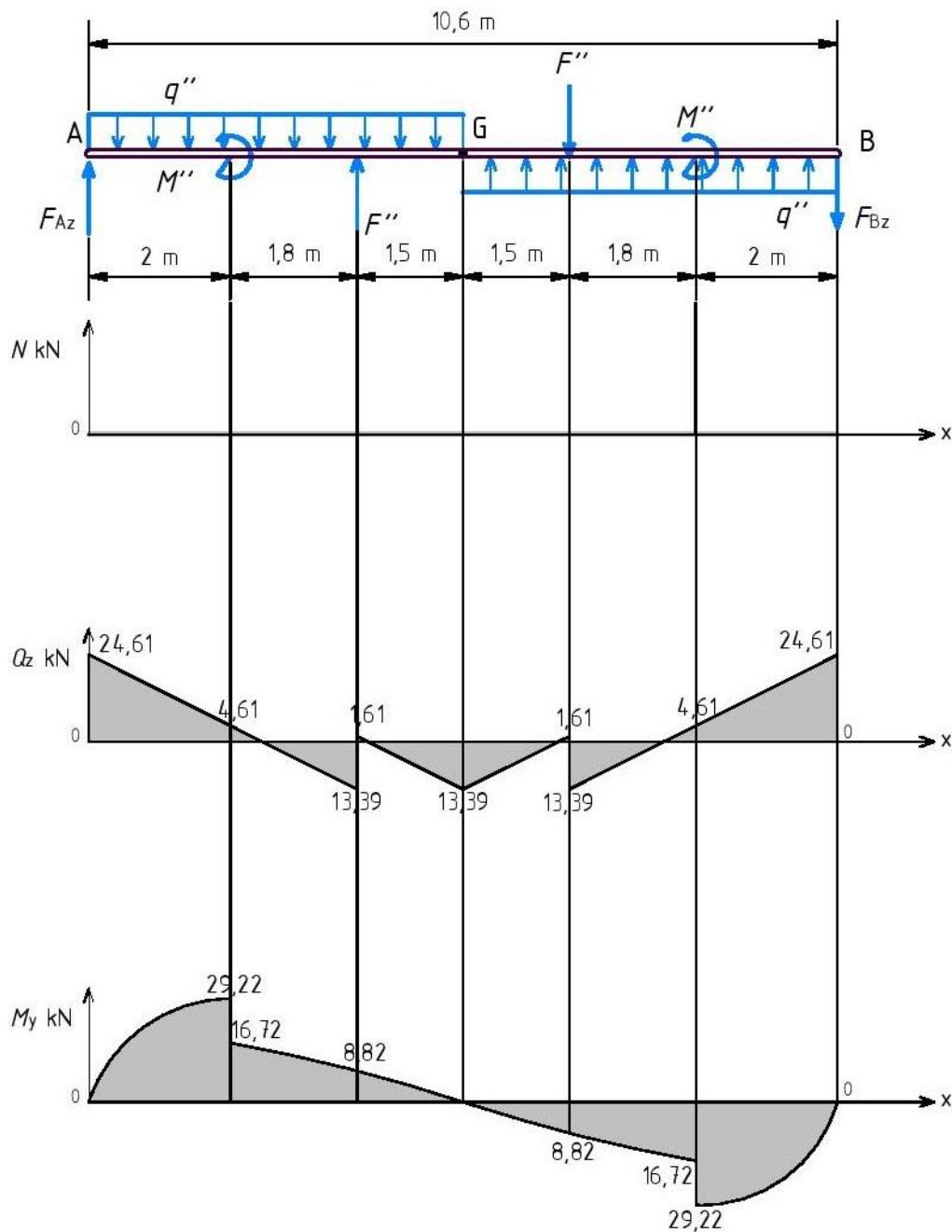
Slika 2.27 - Dijagrami unutarnjih sila asimetrično opterećenog nosača
