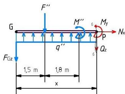
Slika 2.26 - Presjek 6-6 asimetrično opterećenog nosača
