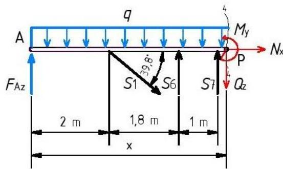
Slika 2.37 - Presjek 4-4 zadano opterećenog nosača
