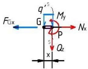
Slika 2.12 - Presjek 5-5 simetrično opterećenog nosača
