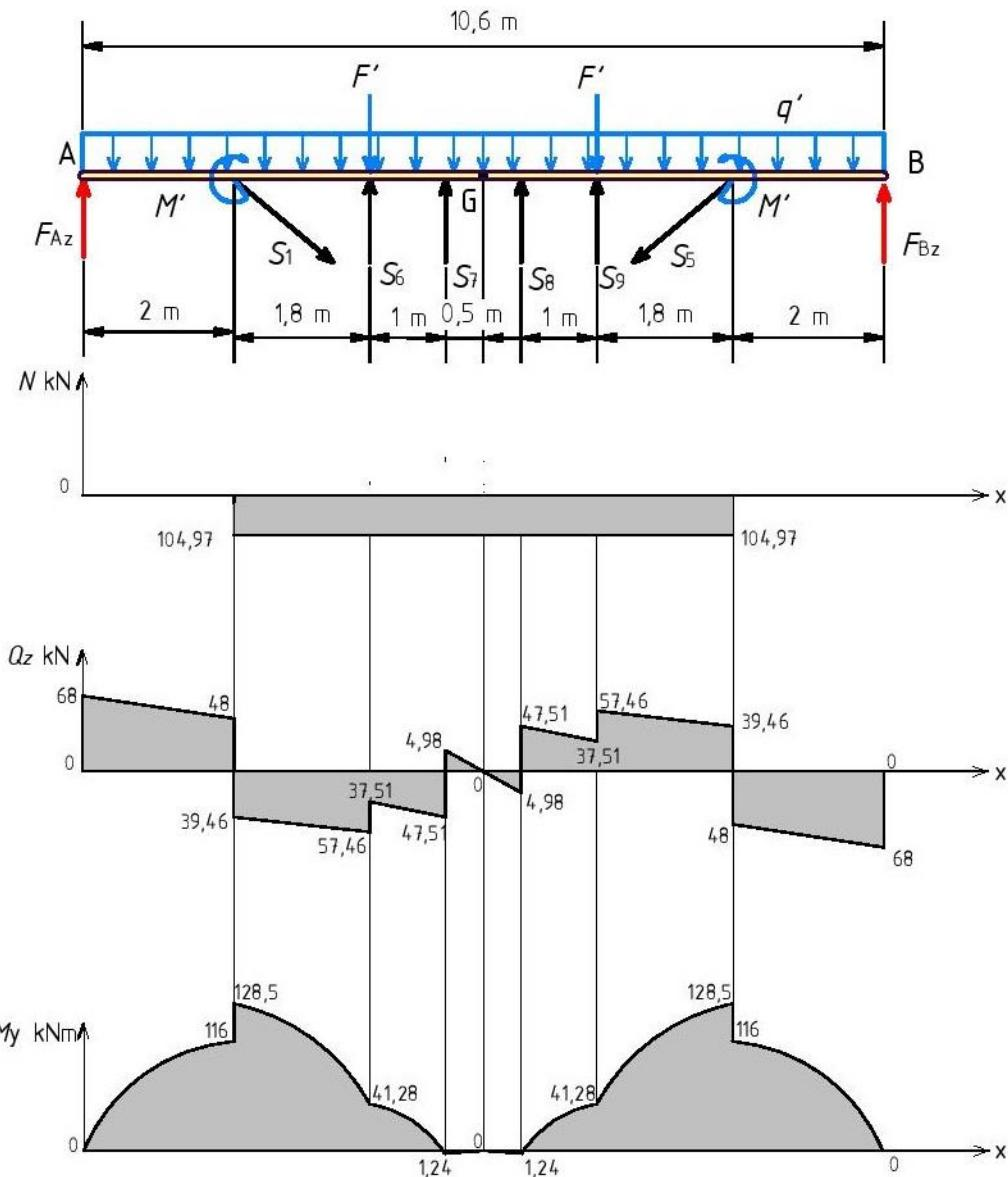
Slika 2.16 - Dijagrami unutarnjih sila simetrično opterećenog nosača
