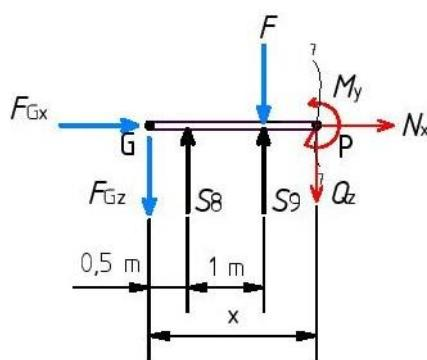
Slika 2.40 - Presjek 7-7 zadano opterećenog nosača
