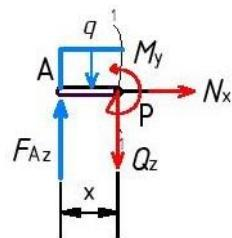
Slika 2.34 - Presjek 1-1 zadano opterećenog nosača
