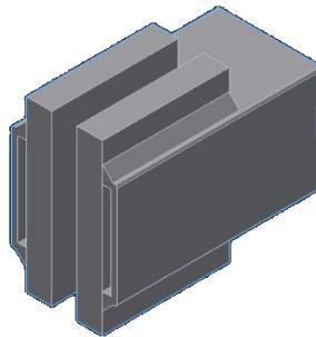
*Slika 5.3 - Urezani kvadratni profil sa zavarenim čeličnim trakama*
