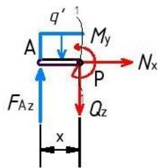
Slika 2.8 - Presjek 1-1 simetrično opterećenog nosača
