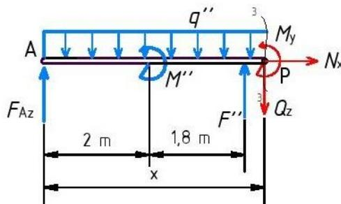
Slika 2.23 - Presjek 3-3 asimetrično opterećenog nosača
