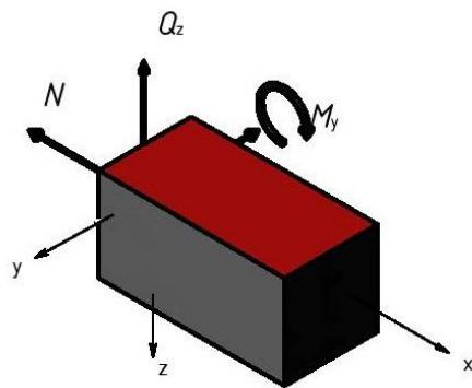
Slika 1.6 - Pozitivne unutarnje sile na negativnom presjeku
