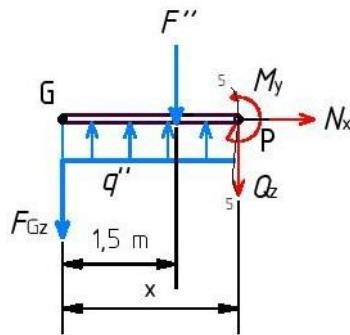
Slika 2.25 - Presjek 5-5 asimetrično opterećenog nosača
