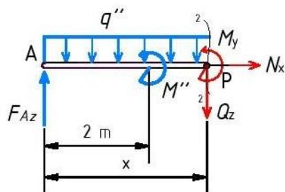
Slika 2.22 - Presjek 2-2 asimetrično opterećenog nosača
