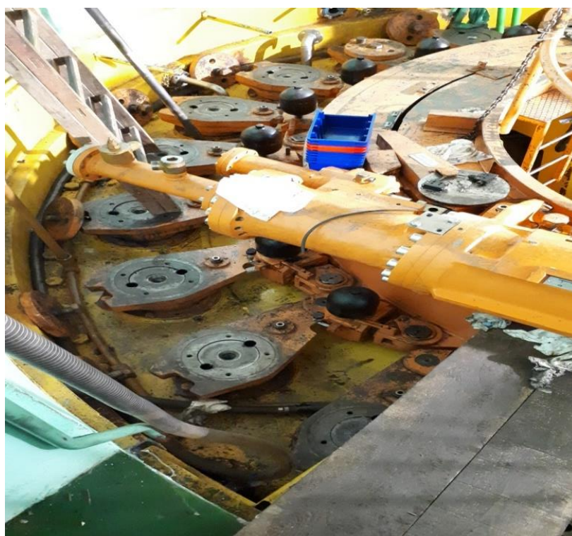
Slika 4. 24. Hidraulički mehanizam lopatica [15]
