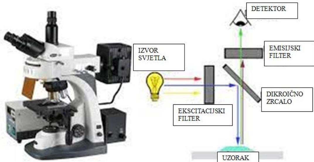
*Slika 3. Dijelovi fluorescentnog mikroskopa*
