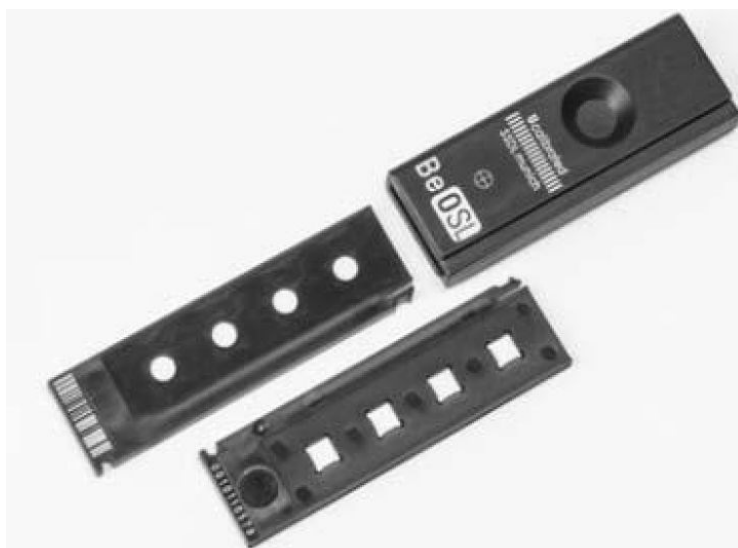
Slika 10. Dozimetar na bazi optički stimulirane luminiscencije
