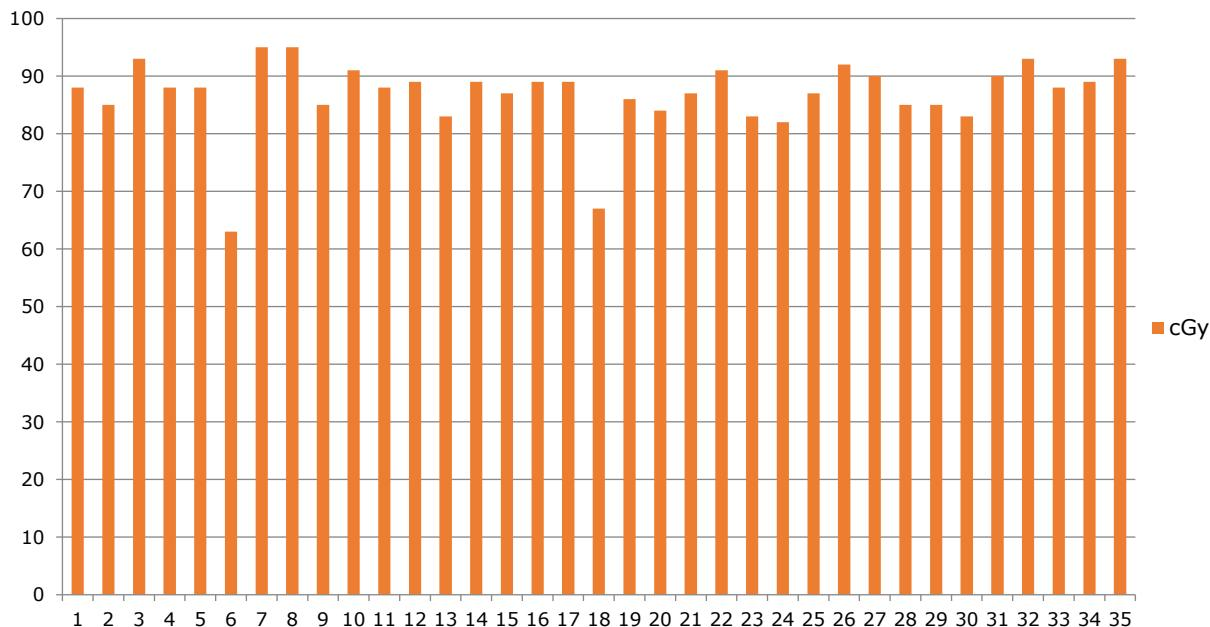
**Slika 8.** Grafički prikaz doze izmjerene TLD u usporedbi s dozom izmjerrenom Farmer komoricom u čvrstom fantomu 3+2+6 za vrijednost zračenja od 100cGy
