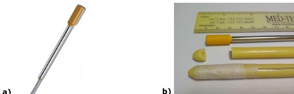
**Slika 13. a)** Poluvodički detektor PFD 39, **b)** PFD 39 prilagođen za mjerjenje u rektumu
