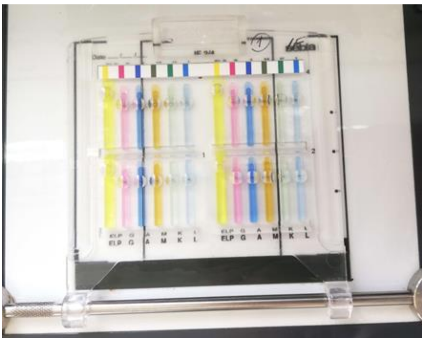
Slika 11. Predložak na površini gela s nanesenim antiserumima.
