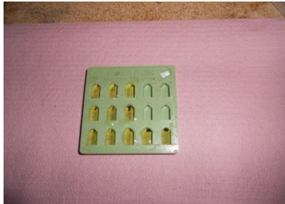
Slika 16. Uklapanje u čistu Durcupan smolu
