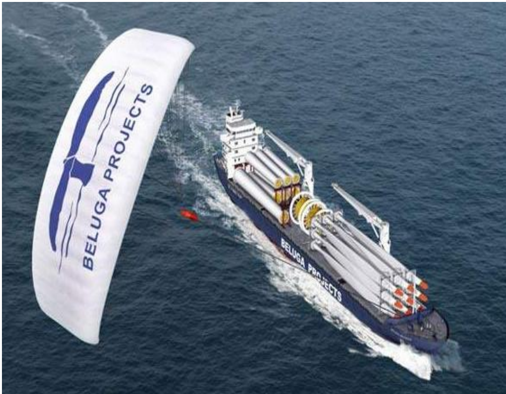
Slika 17. Prikaz modernog broda Beluga SkySails s razvijenom tehnologijom nebeskog jedra [28]
