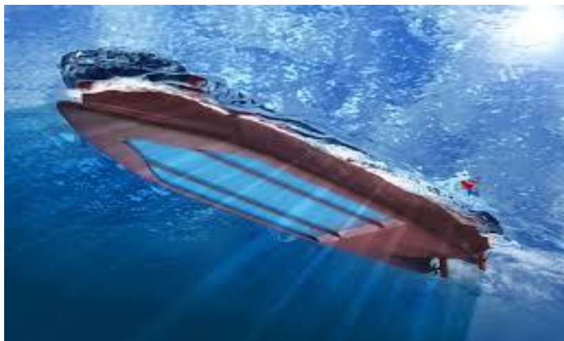
Slika 6. Brod sa zračnom šupljinom [preuzeto sa www.marineinsight.com ]
