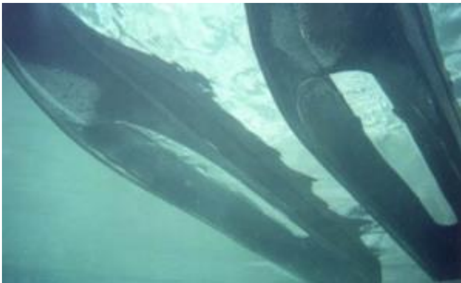
Slika 10. Prikaz šupljine u trupu ispunjene zrakom [preuzeto sa www.yachtboutique.com ]
