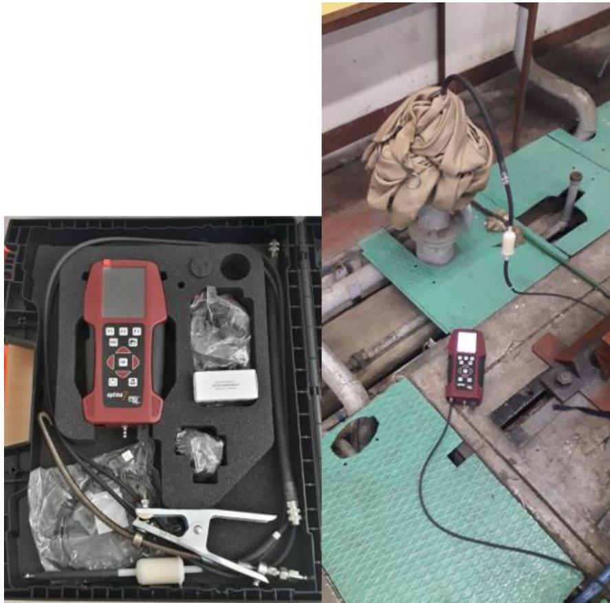
**Slika 18. Prikaz mjernog uređaja i njegove instalacije za obavljanje mjerenja**
