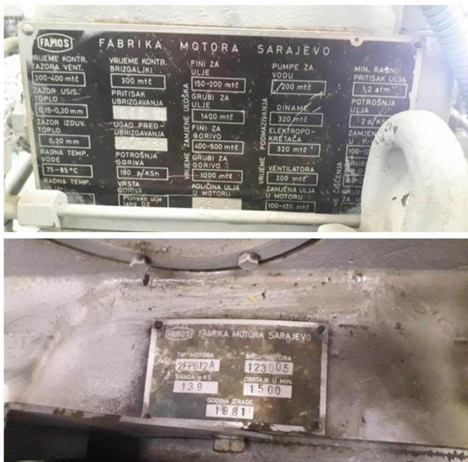
**Slika 17. Tehnički podaci dizelskog motora marke FAMOS**
