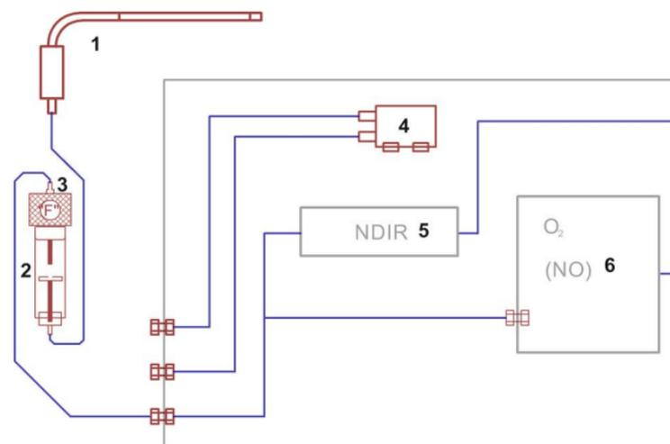
**Slika 7. Dijagram toka plinova za Optima 7 NDIR [16]**
