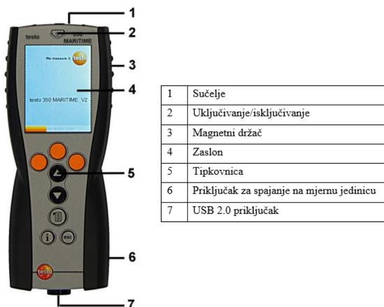
**Slika 13. Kontrolna jedinica mjernog uređaja Testo 350 Maritime [19]**
