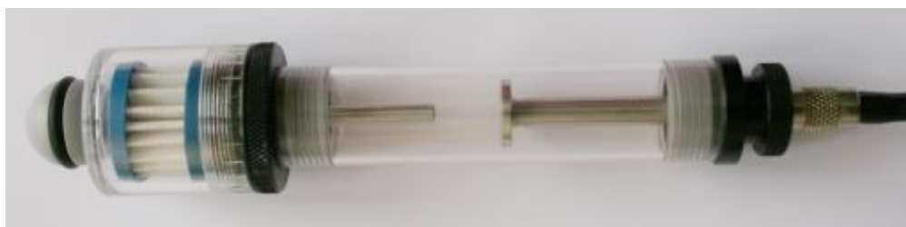
Slika 12. Odvajač kondenzata na uređaju Optima 7 NDIR [16]
