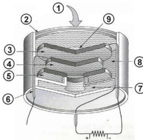
Slika 9. Prikaz elektrokemijskog senzora u presjeku [16]
