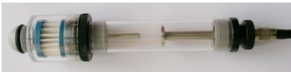
Slika 12. Odvajač kondenzata na uređaju Optima 7 NDIR [16]
