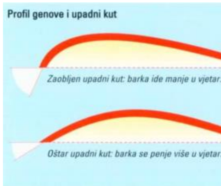
Slika 7. Profil genove i upadni kut [3]
