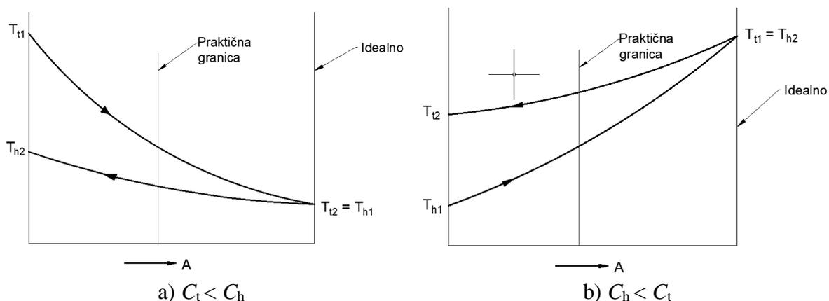
**Slika 22. Najveća moguća promjena temperatura protustrujnog izmjenjivača topline**
