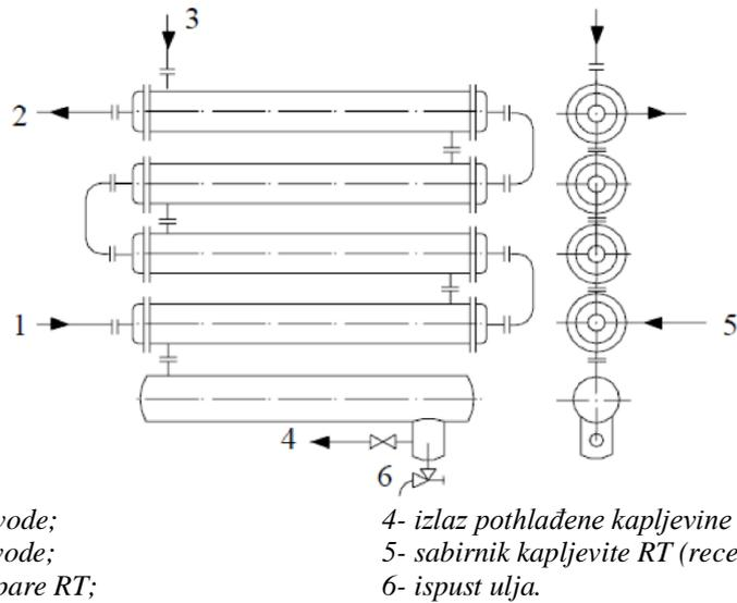
**Slika 8. Protustrujni kondenzatori koji su međusobni povezani [3]**
