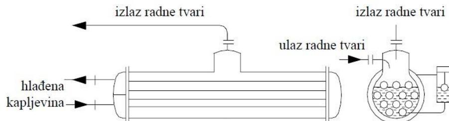
**Slika 15. Potopljeni isparivač s cijevima u plaštu [3]**
