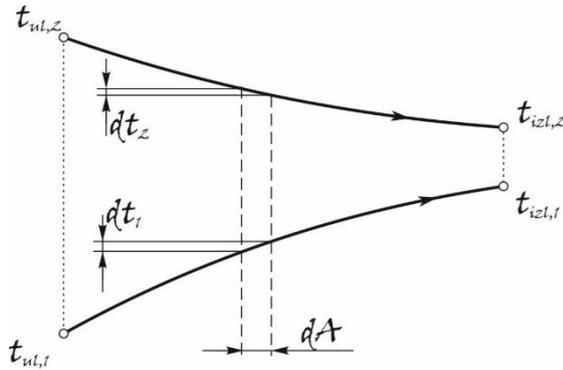
**Slika 20. Profil temperatura kod istostrujnog izmjenjivača topline**
