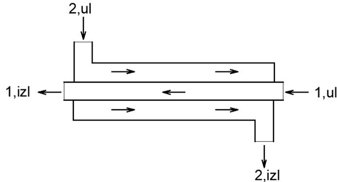
**Slika 23. Tijek tekućine u protustrujnom izmjenjivaču topline**
