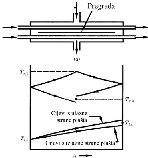
Slika 4. Izmjenjivač toplote s razdvajanjem tekućine [1]
