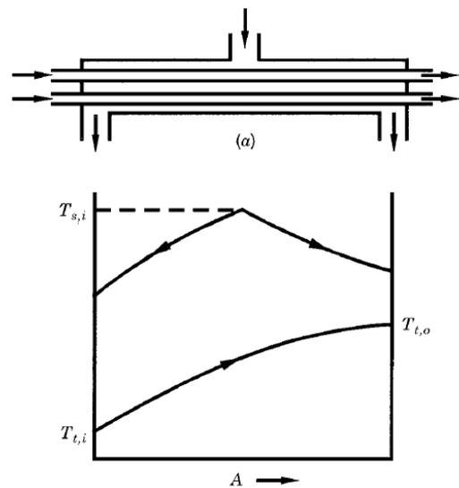
Slika 5. Izmjenjivač toplote s dijeljenjem tekućine [1]
