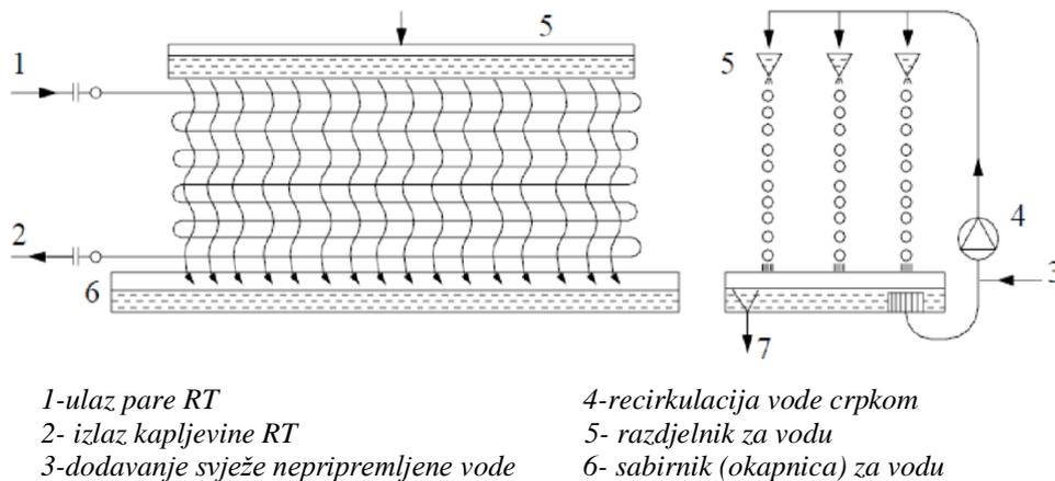
**Slika 11. Atmosferski kondenzator [3]**
