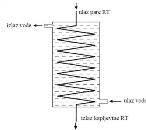
**Slika 6. Kondenzator sa cijevnom zavojnicom u bubnju [3]**
