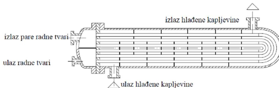
**Slika 17. Isparivač za hlađenje kapljevine sa suhim isparivanjem [3]**
