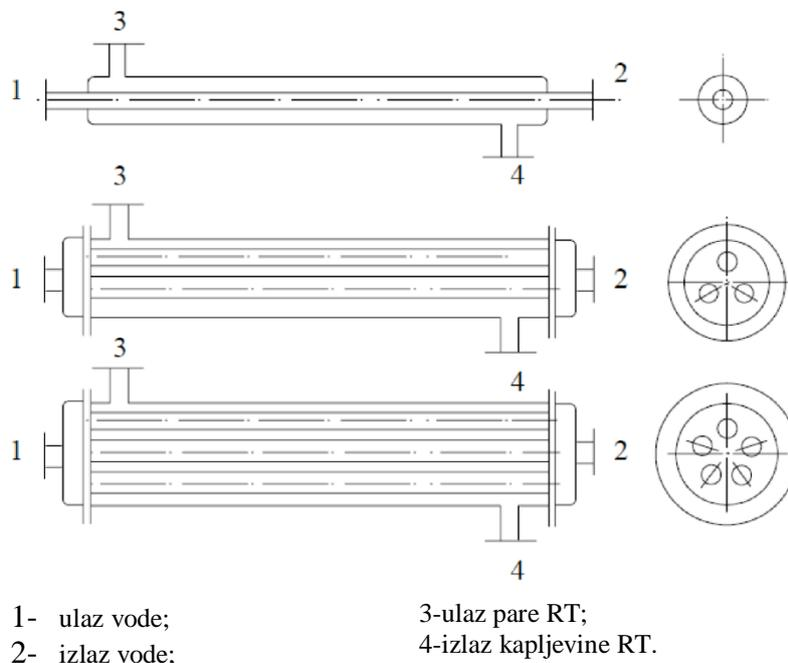
**Slika 7. Protustrujni kondenzator [3]**
