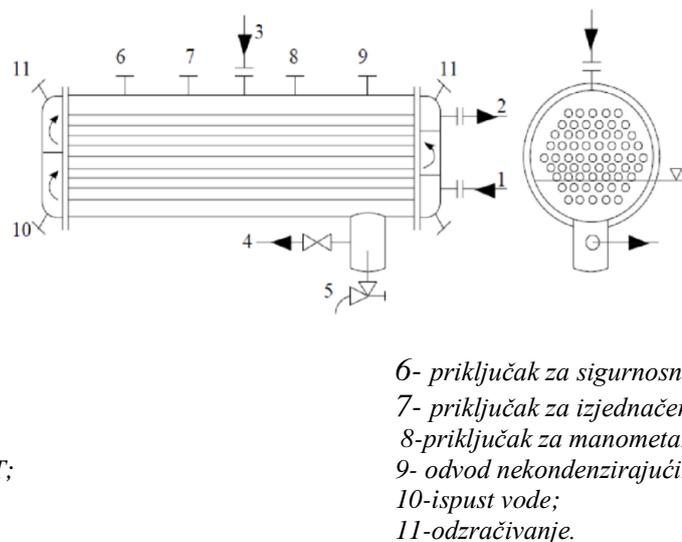
**Slika 9. Kondenzator sa snopom cijevi u plaštu [3]**
