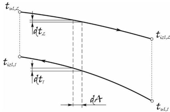
**Slika 21. Profil temperatura kod protustrujnog izmjenjivača topline**
