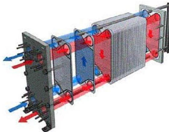
**Slika 19. Pločasti izmjenjivač [4]**
