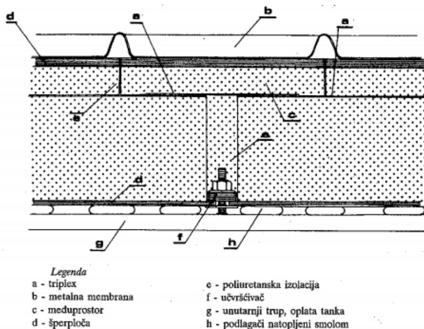
**Slika 15. Izolacija tanka s metalnom membranom [8]**
