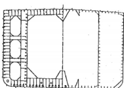
Slika 10. Poprečni presjek broda tankera na glavnom rebru [6]
