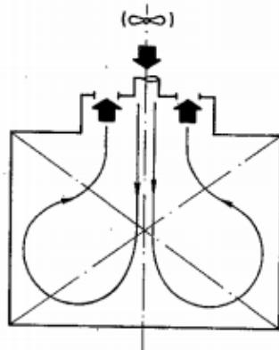
**Slika 18. Ventilacija s tlačnim prijenosnim ventilatorom [8]**
