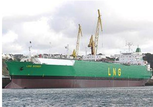
Slika 7. LNG tanker membranskog tipa [18]
