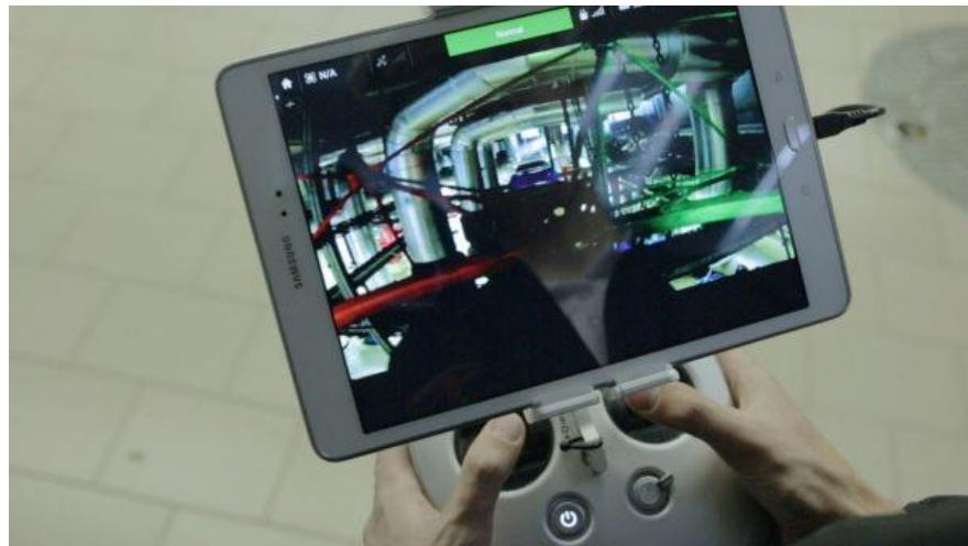
**Slika 24. Prikaz nadzora brodskih sustava preko videoprijenosu s bespilotne letjelice**
