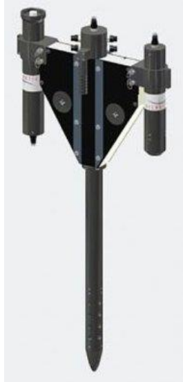
Slika 3.2 Sonda Satlantic HyperPro [9].
