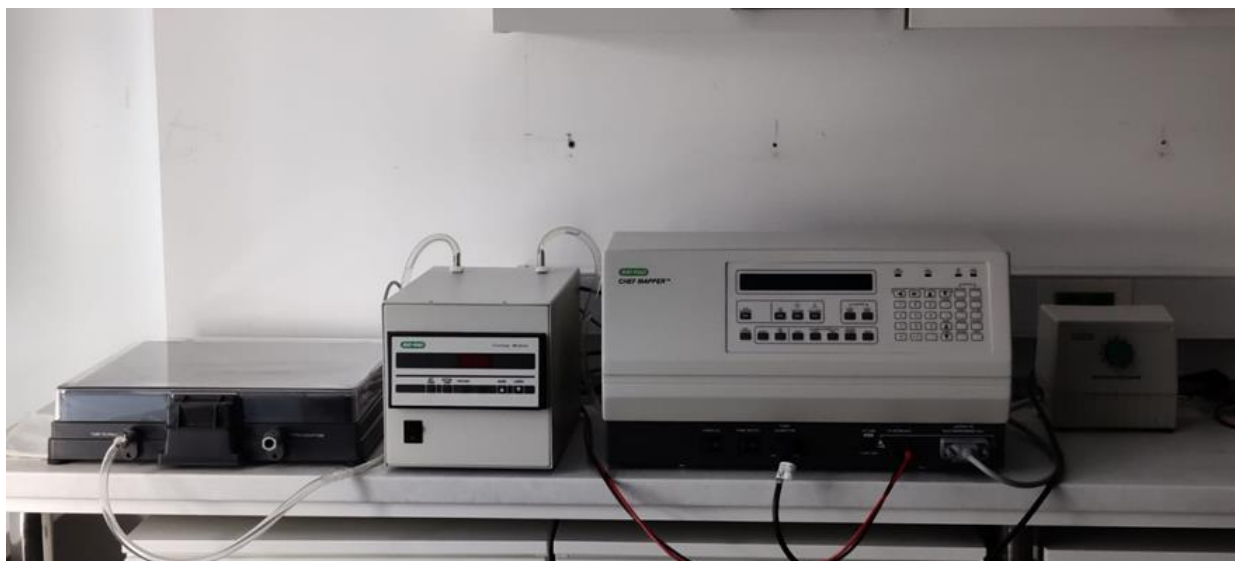
Slika 5. Uređaj za provođenje PFGE elektroforeze.
