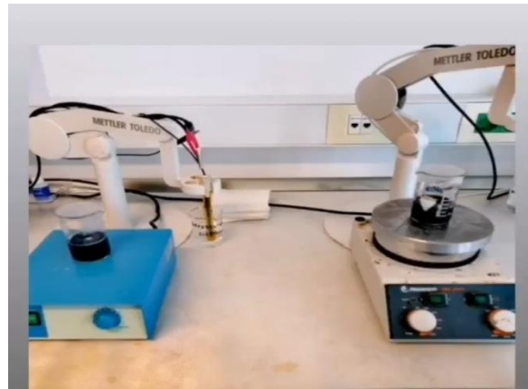
Slika 7. Uzorci na magnetskoj miješalici
