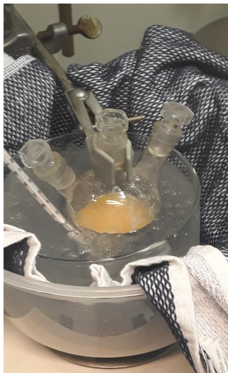
Slika 10: Reakcijska smjesa nakon dodatka cijele otopine broma
