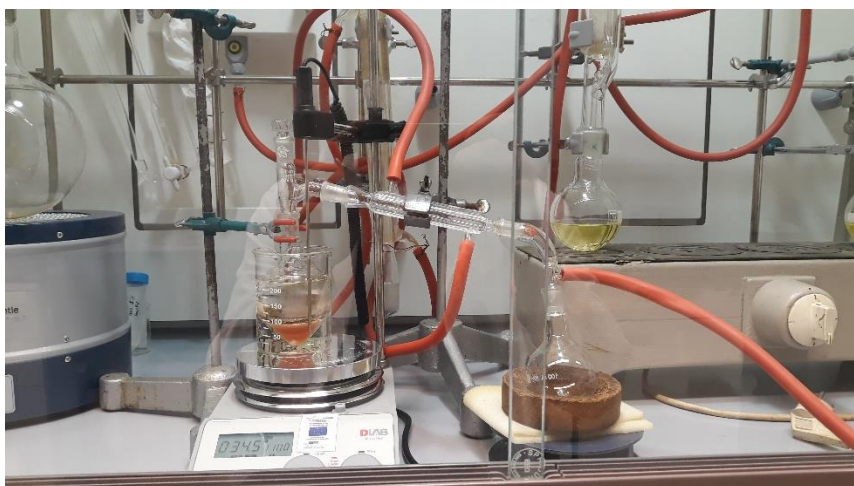
Slika 15: Destilacija pri sniženom tlaku
