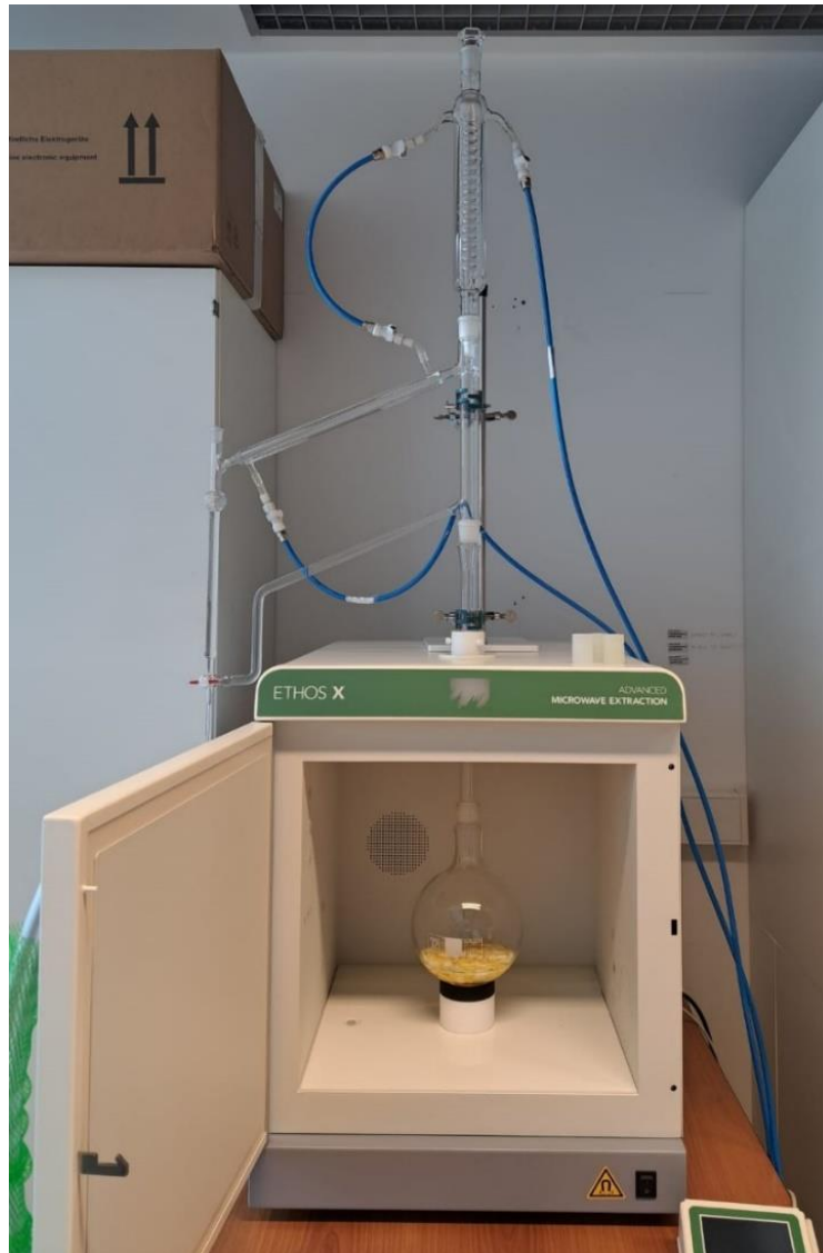
Slika 4. Unutrašnjost mikrovalnog uređaja za ekstrakciju eteričnog ulja smješten na Odjelu za biologiju
