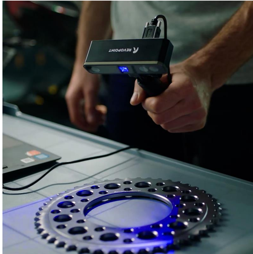
Slika 2.11 – Ručno skeniranje zupčanika [10]
