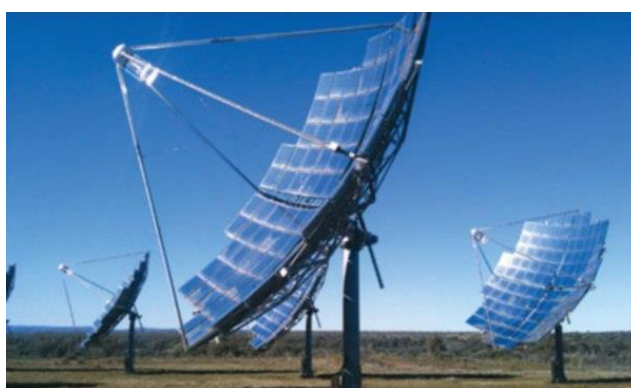
Slika 3. Solarna elektrana s paraboličkim solarnim tanjurima [16]
