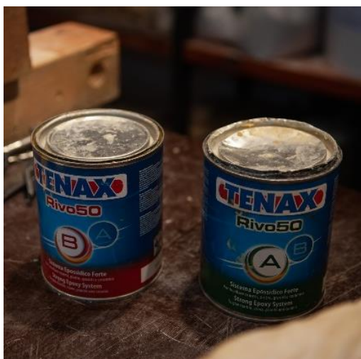
Slika 40 Epoksidno dvokomponentno ljepilo (autor: Rina Dubravec)
