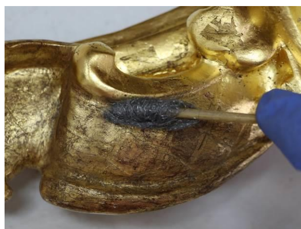
Slika 278 Površina pozlate tijekom habanja čeličnom vunom
