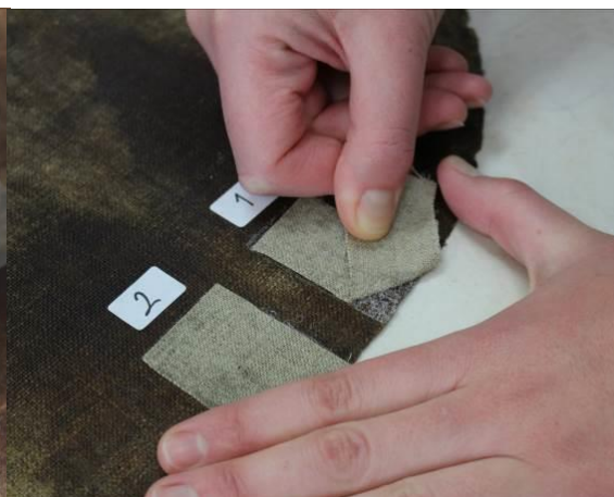
Slika 146 Provjera vezivne snage Beva-e iz probe (1) nanese u jednom sloju
