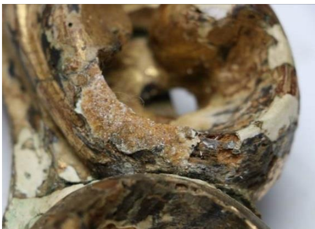
Slika 227 Rekonstrukcija u kitu na donjem dijelu ukrasnog okvira prije uklanjanja kita
