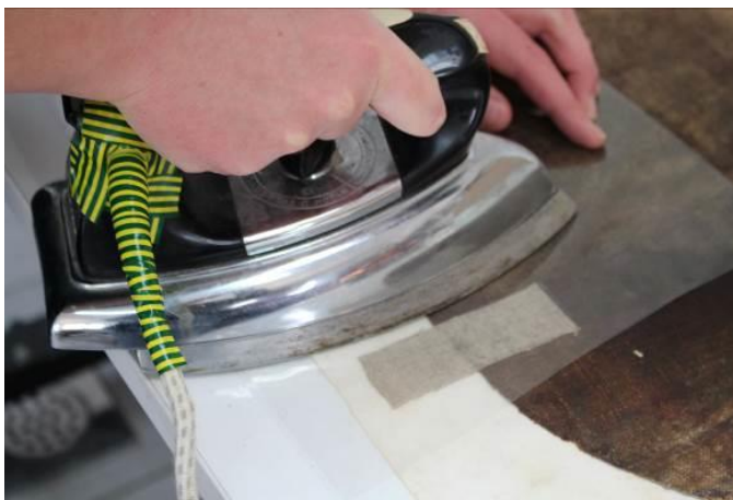
Slika 145 Reaktivacija Beva-e nanesenih proba vrućom peglom
