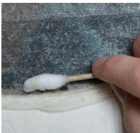
Slika 136 Reaktivacija Plextola B500 valjanjem vatenog tampona s acetonom
