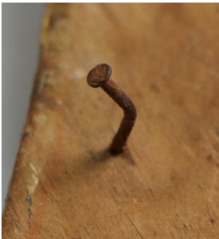
Slika 58 Korodirani čavao kojim je slika bila držana u okviru, detalj
