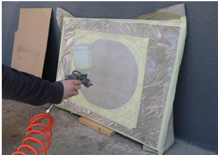
Slika 142 Nanošenje trećeg sloja Beva-e na kompresorom u ocrtanu zonu
