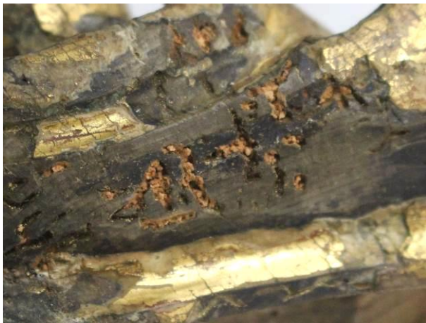
Slika 238 Crvotočina u donjem dijelu ukrasnog okvira ispunjena je grubim Lopudskim kitom koji služi kao baza za fini kit
