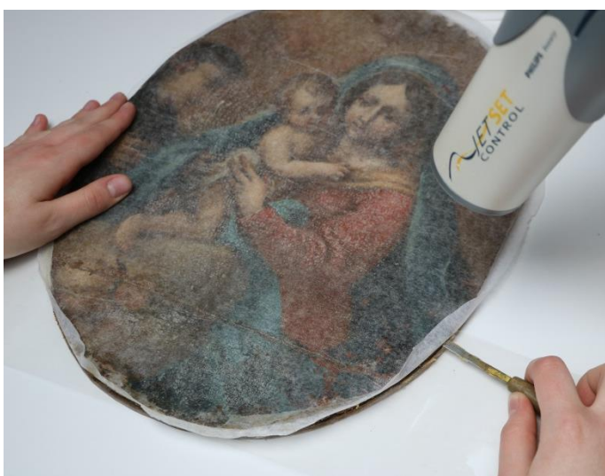
Slika 122 Omekšavanje voska fenom i odvajanje slike od ploče špahtlicom, proba (2)
