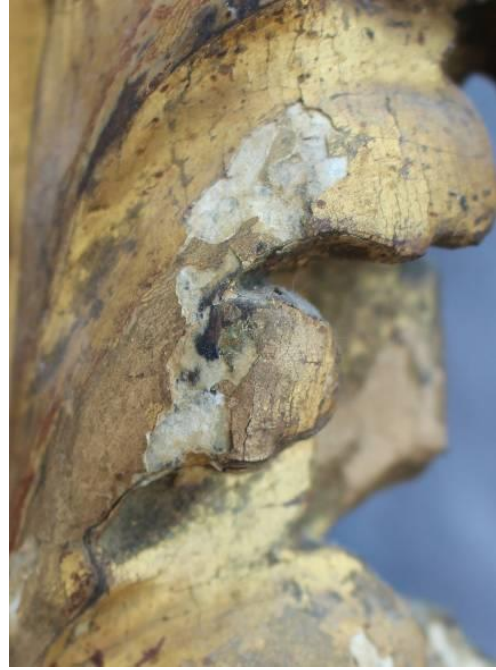
Slika 81 Sloj pozlate otpao zajedno sa slojem preparacije zbog raslojavanja preparacije, detalj
