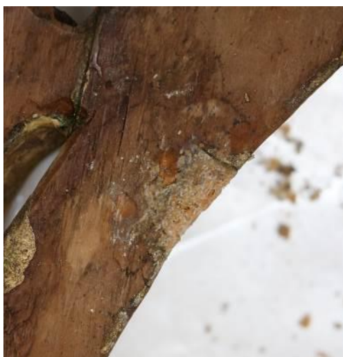
Slika 229 Rekonstrukcija u kitu na unutarnjem rubu ukrasnog okvira prije uklanjanja kita
