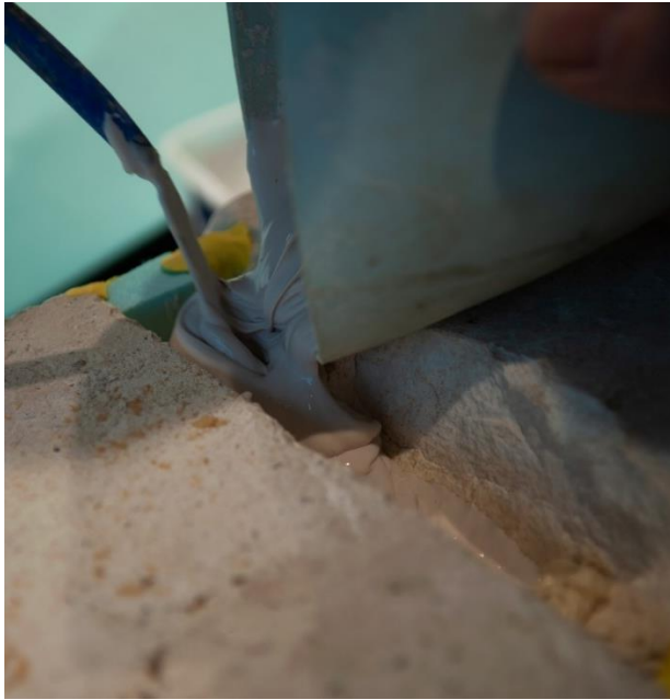
Slika 56 i Slika 57 Lijevanje Acrytalne smjese (autor: Mladen Matijaca)
